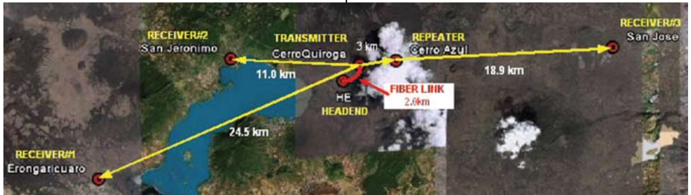
Red troncal de microondas: un transmisor en Cerro Quiroga alimenta tres receptores a distancias de 11, 24.5 y 18.9 Km (uno de ellos a través de un repetidor).
